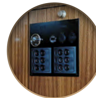
Tablica BEP na frezowanej PLEXI (Frezowana nazwa jednostki + otwory pod wskaźniki).
