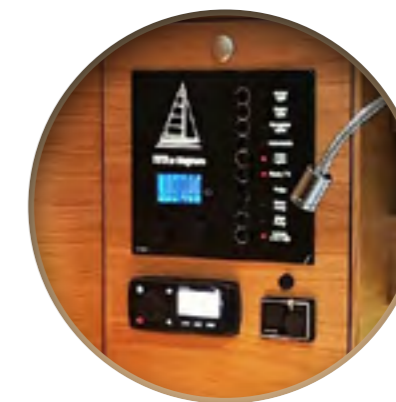
Tablica Amperflex z rycina łódki, mini monitorem pokazującym stan naładowania akumulatorów oraz zapewnienia ziorników, posiada porty ładowania USB i 12V.
