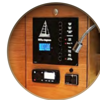
Tablica Amperflex z ryciny łódki, mini monitorem pokazującym stan naładowania akumulatorów oraz zapełnienia ziorników, posiada porty ładowania USB i 12V.
