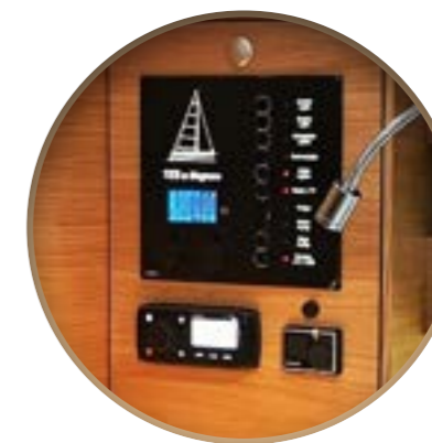
Tablica Amperflex z rycina łódki, mini monitorem pokazującym stan naładowania akumulatorów oraz zapelnienia ziorników, posiada porty ładowania USB i 12V.
